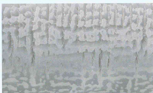
図1 従来型70 \mu mナイロン (ウェット時) F 1 general nylon612-70 \mu m brush(wet condition)
